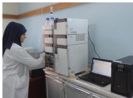
وهو جهاز كروماتوغرافيا السائل العالي الاداء High Performance Liquid chromatography من اهم واحداث الاجهزة التي تستخدم في فصل وتحليل والتعرف وتحديد المركبات الكيميائية كماً ونوعاً. يستخدم في تحليل البروتينات والدهون في الكشف عن آثار السموم وبقايا المبيدات وغيرها من المركبات الخطرة التي يمكن ان يتلوث بها الماء والغذاء والنبات والتربة.
