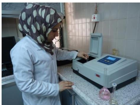
هو جهاز يستعمل لقياس الخواص الضوئية عبر نطاق معين من طيف الموجات الكهرومغناطيسية، وبصفة خاصة يقوم بالتحليل الضوئي للتعرف على مكونات المواد وتركيزها . وهو يقوم بقياس طول الموجات الضوئية بوحدة النانومتر ، بالإضافة الى انه يستعمل للتحليلات المعقدة التي تتضمن دراسة الأشعة الكهرومغناطيسية المنبعثة أو الممتصة من المادة.
