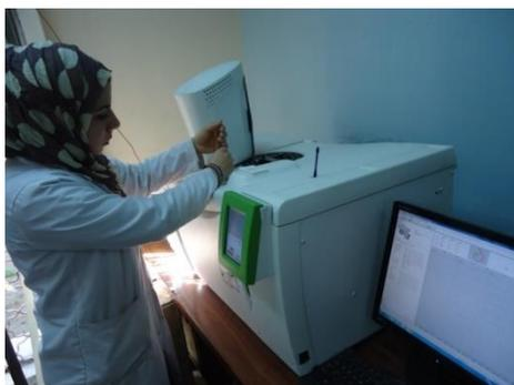
١. تقنية الكروماتوغرافيا الغازية المتصل بمطياف الكتلة و التي تسمى GC\_ MS : وهي اختصار لـ Gas Chromatography–Mass Spectrometry تعتبر من اهم التقنيات المستعملة في المختبرات العالمية وهي طريقة فعالة من اجل فصل وكشف المركبات العضوية القابلة للتطاير ومزيج من الغازات من مركبات عضوية مثل تحليل الزيوت العطرية والأحماض الدهنية والهيدروكربونات والفينولات ومتبقيات المبيدات فضلاً عن التحري على بعض المنشطات الرياضية والادوية والمخدرات في دم الانسان.
