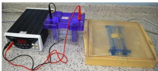
يستخدم هذا الجهاز في فصل البروتينات عند نقطة التعادل الكهربائي فيما بينها
