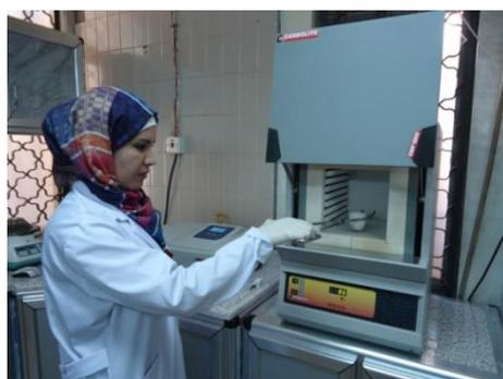
هو عبارة عن غرفة حرارية مفرغة من الهواء تصل درجة حرارتها الى ١٢٠٠ درجة مئوية يستعمل لحرق وترميد العينات من اجل التخلص من المركبات العضوية وتحويلها الى رماد حاوي على المركبات اللاعضوية المطلوبة في التحليل.
